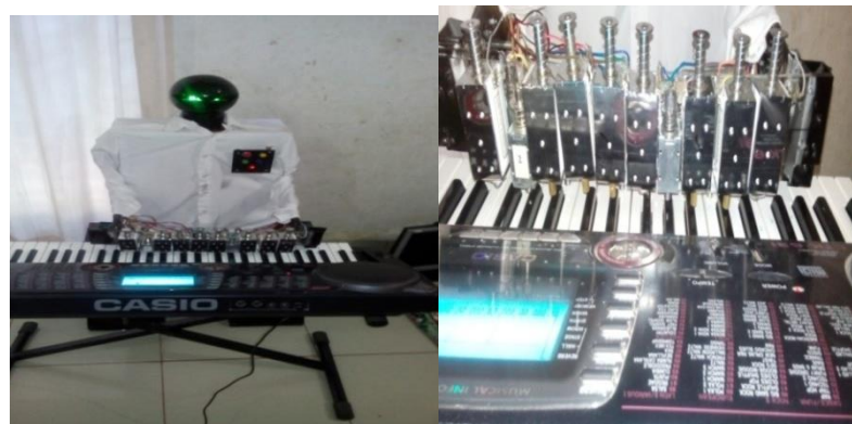
Gambar 9. Kiri: Casio Kanan: Posisi Solenoid Pada Tuts Piano Casio
