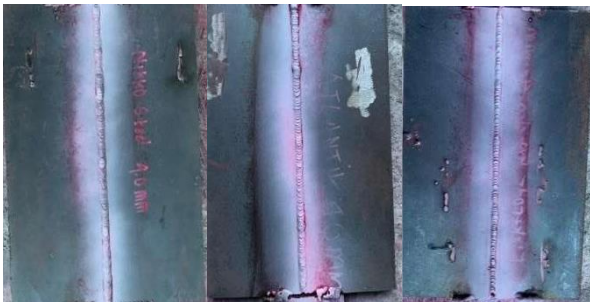
Gambar 7. Pengaplikasian developer pada capping
