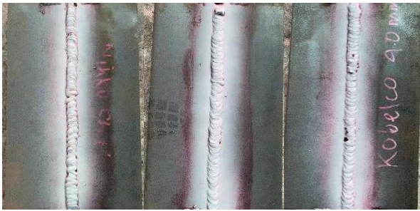
Gambar 6. Pengaplikasian developer pada capping
