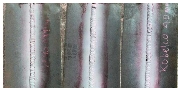
Gambar 6. Pengaplikasian developer pada capping
