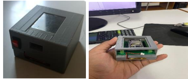
Gambar 13. Bentuk versi kedua dari alat portable
