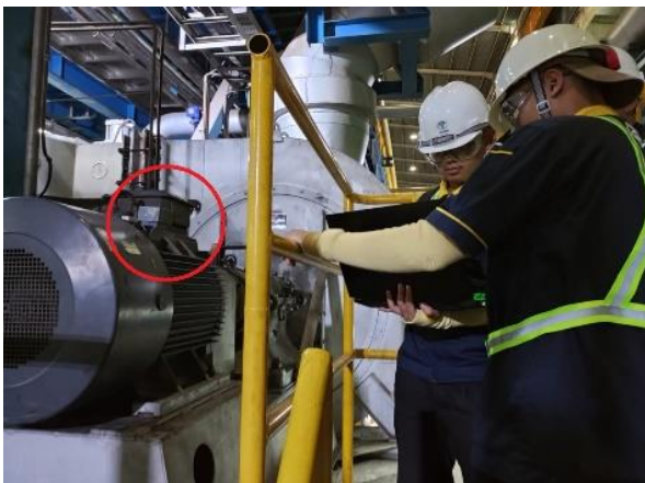
Gambar 8. Posisi alat ukur pada motor Pengujian di PT. TML juga dilakukan dengan melibatkan mahasiswa dalam proses pengukuran pemasangan serta ujicoba alat.
