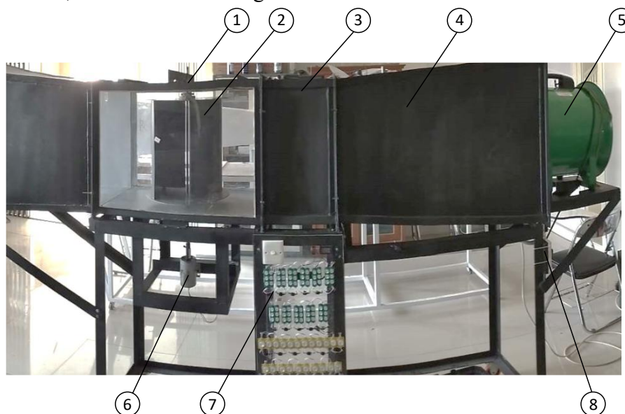
Gambar 2. Skema Alat Pengujian, 1) Pillow Block; 2) Test Section dengan turbin; 3) Honeycomb section; 4) Difusser section; 5) Blower; 6) DC Generator; 7) Beban Lampu; 8) Saklar on/off
