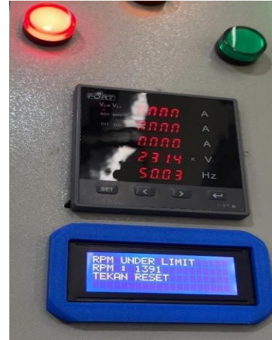
Gambar 11. Tampilan LCD ketika motor berputar under speed
