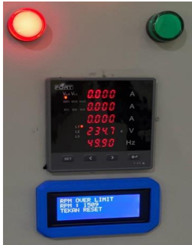
Gambar 12. Tampilan LCD ketika motor berputar over speed
