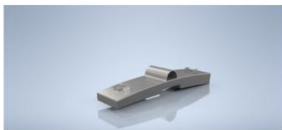
(b) Spesimen yang memiliki ketebalan keausan berbeda
