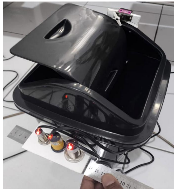
Gambar 7. Pengujian Smart Sorting Trash Box menggunakan sampah Logam
