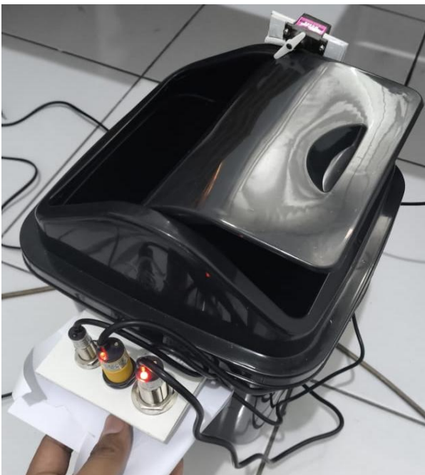
Gambar 6. Pengujian Smart Sorting Trash Box menggunakan sampah Non-Logam
