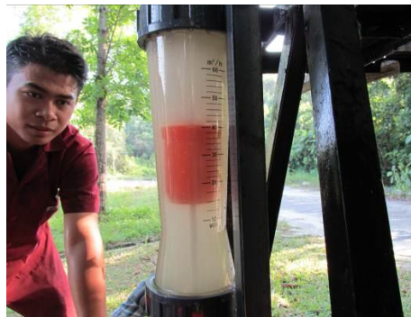
Gambar 5. Pengambilan Data Debit Air
